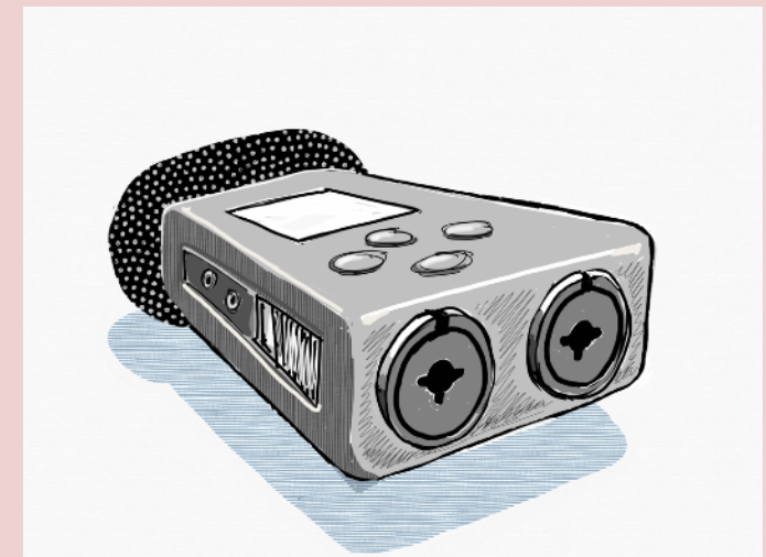
Professionelles Aufnahmegerät mit XLR-Anschlüssen für externe Mikrofone
